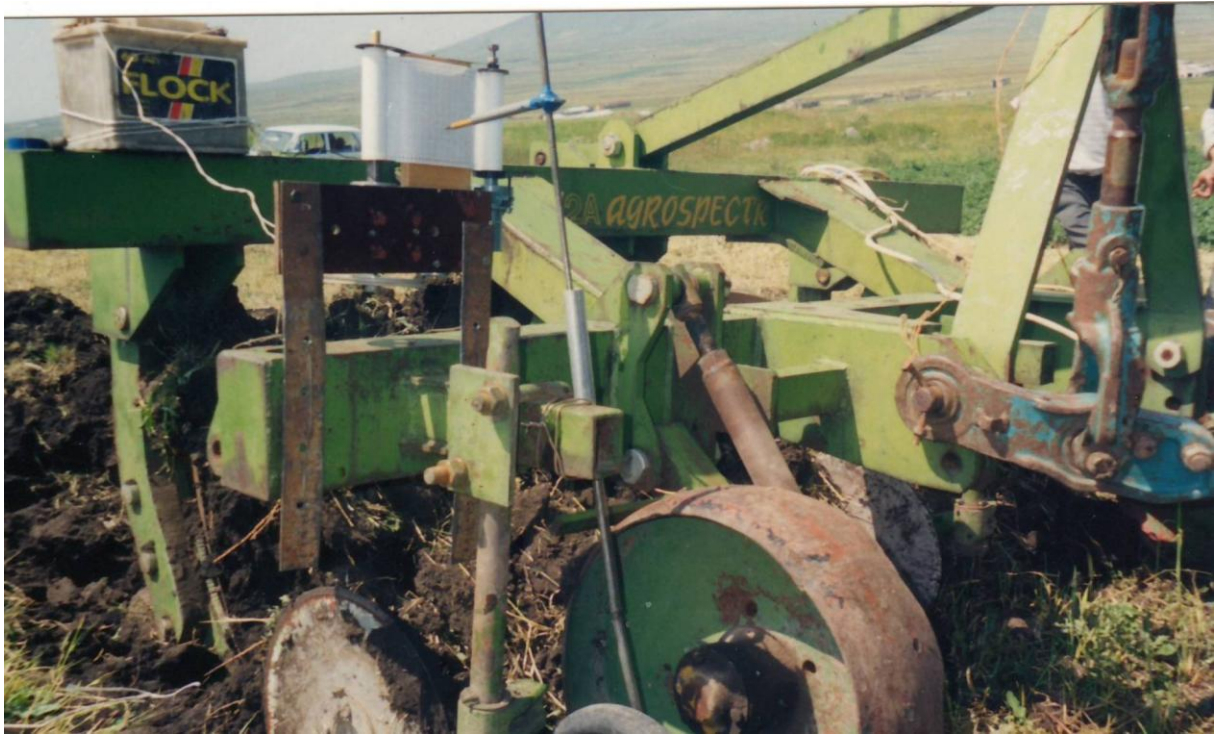
Նկ. 3.5. Հողամշակ մեքենայի բանող օրգանի ընթացքի խորության գրանցումը
