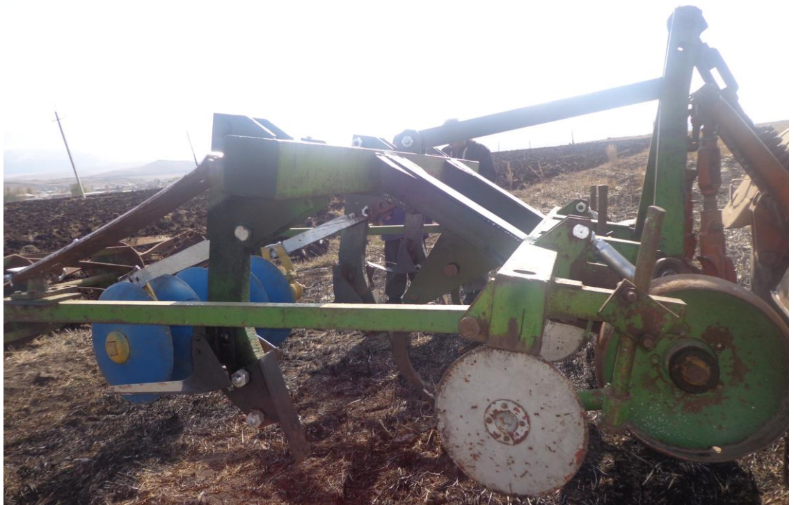
Նկ.5.4. Լանջերի հողի շերտավոր մշակման ագրեգատ
