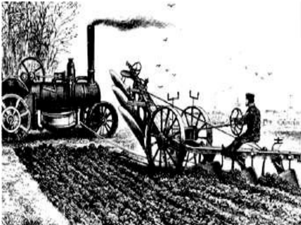
Նկ.1.7. Մաքս Այթի ինքնաշարժ շոգեգութանը
