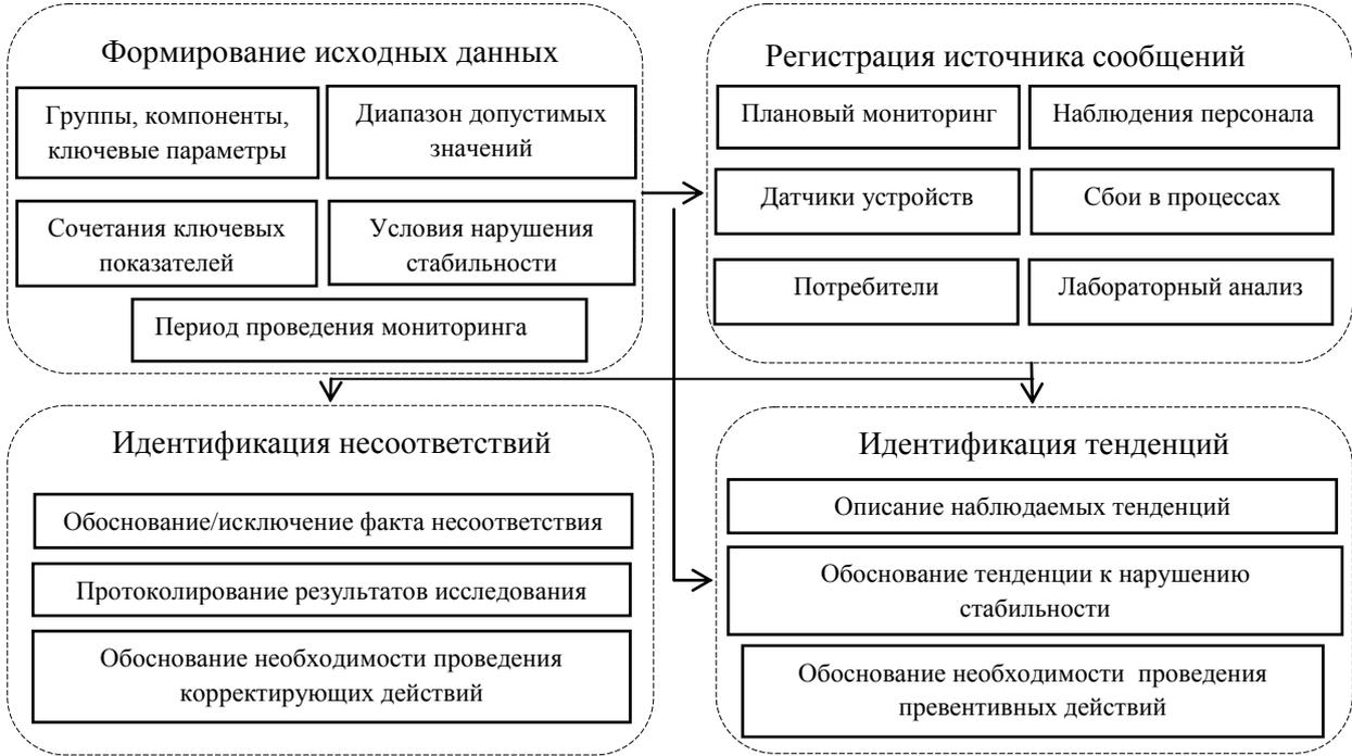
Рисунок 2.5. Структурно-функциональная схема обнаружения и идентификации несоответствий.
