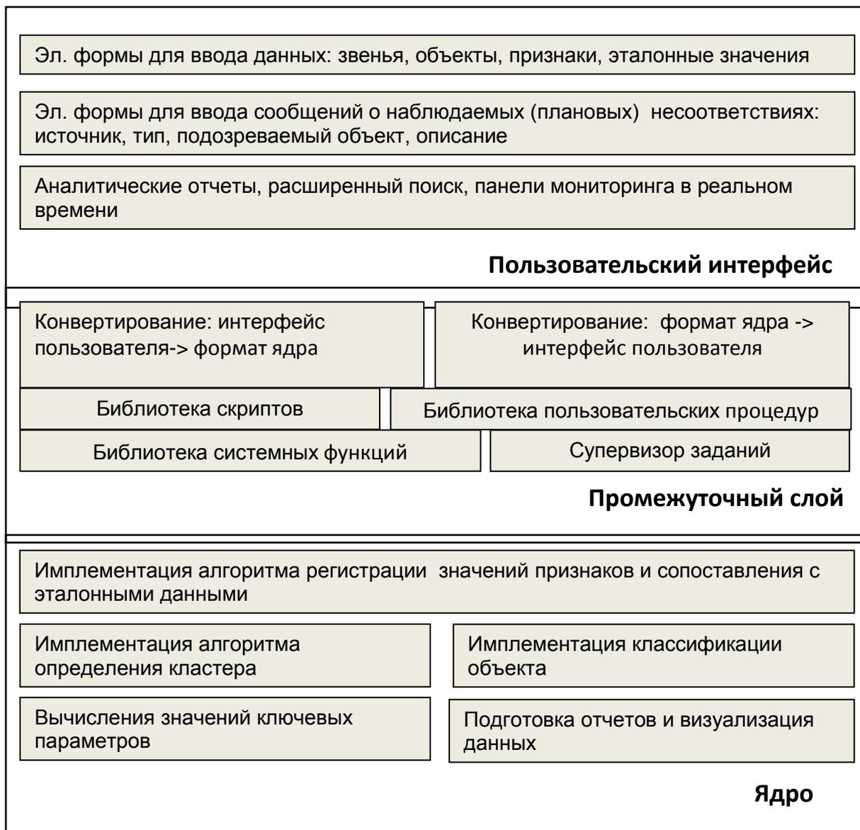
Рисунок 3.12. Трехуровневая логическая структура информационной системы BVR QMS.
