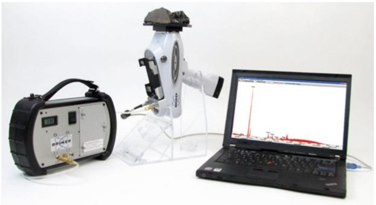
Նկար 2. Brucker III SD մակնիշի սպեկտրոմետրը իր համապատասխան ծրագրային փաթեթով
