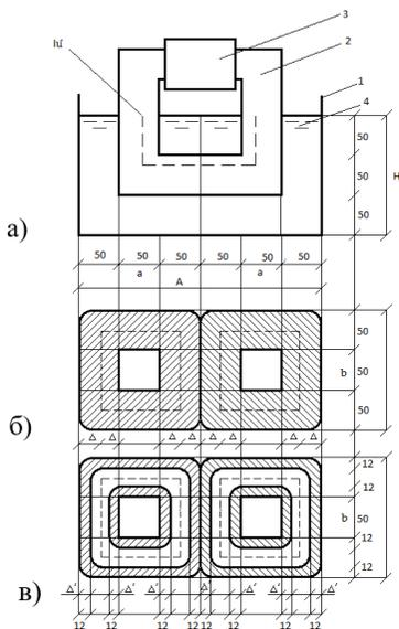
Рис. 4. Общий вид, вырез “типовой” канальной печи (а), проекции глубины проникновения тока при плавлении олова (б) и алюминия (в)
