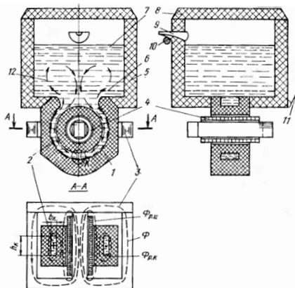
Рис. 2. Индукционная каналная печь для плавки металлов
