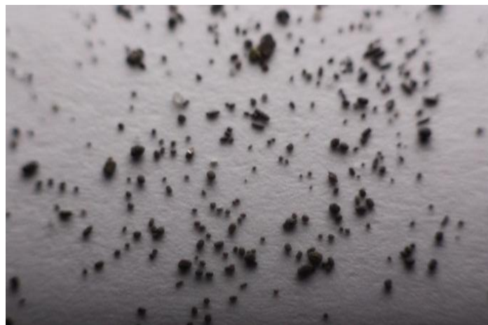
Նկ. 4.22. 0,4 գ գնդավածով հարստացված այրուքի մակրոկառուցվածքը ( \times 100 )
