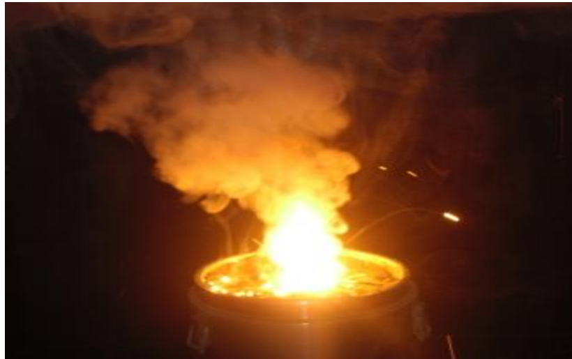
Նկ. 4.13. Ածխածնային խտանյութի ալյումինաթերմային վերականգնման գործընթացը բովախառնուրդի այրման պահին
