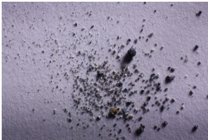
Նկ. 4.20. Աղաթթվով տարրալուծմամբ՝ ազնիվ մետաղների պարունակող խառամի մակրոկառուցվածքը ( \times 100 )
