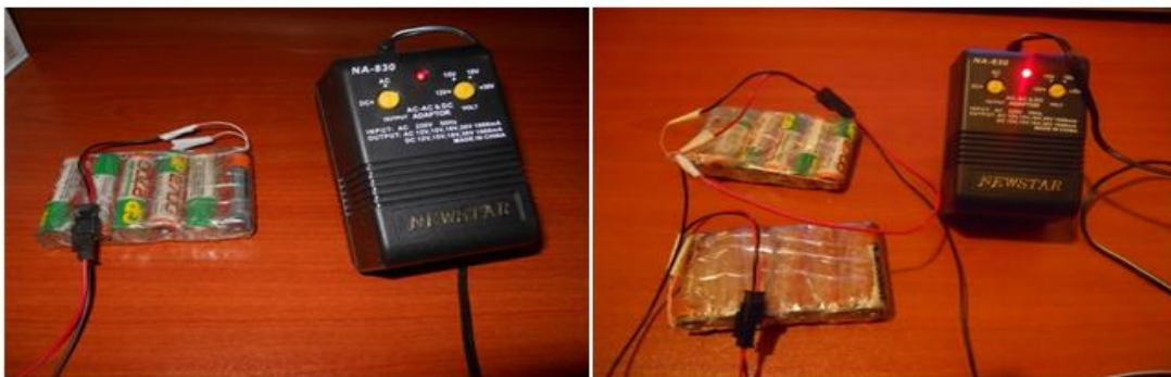
Рис. 3.10. Внешний вид аккумуляторов типа GP и универсального зарядного устройства типа NEW STAR NA-830.
