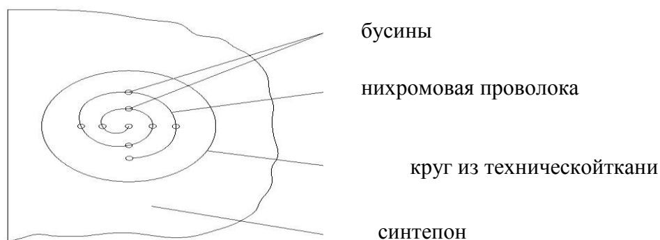
Рис. 3.3 Схема установки нихромовых спиральных нагревателей в комбинезоне
