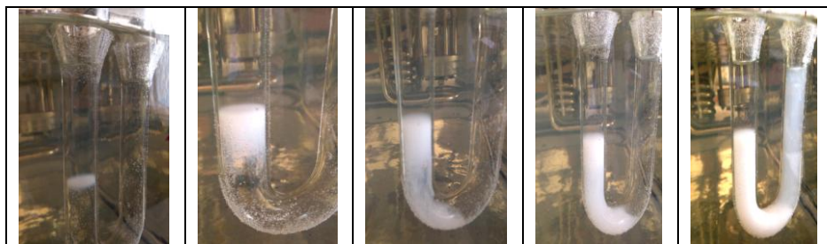
Рис. 2. Топологическая картина помутнения водной фазы в системе раствор винилацетата в метаноле – 0.4 % водный раствор персульфата калия в разные промежутки времени наблюдения.
