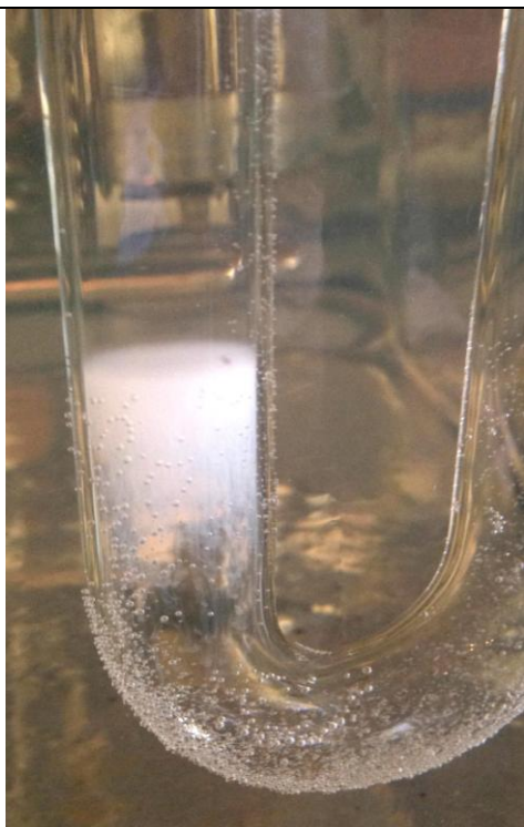
Рис. 2.2. Топологическая картина помутнения водной фазы в системе раствор винилацетата в метаноле – 0.4 % водный раствор, время наблюдения 50 мин.
