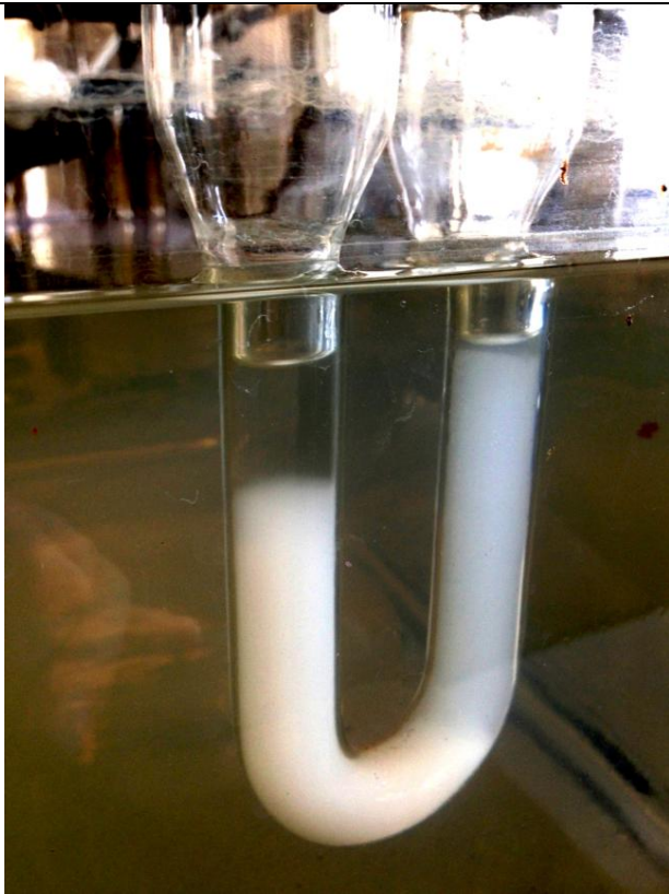
Рис. 2.8. Топологическая картина помутнения водной фазы в системе раствор винилацетата в метаноле – 0.4 % водный раствор, время наблюдения 210 мин.
