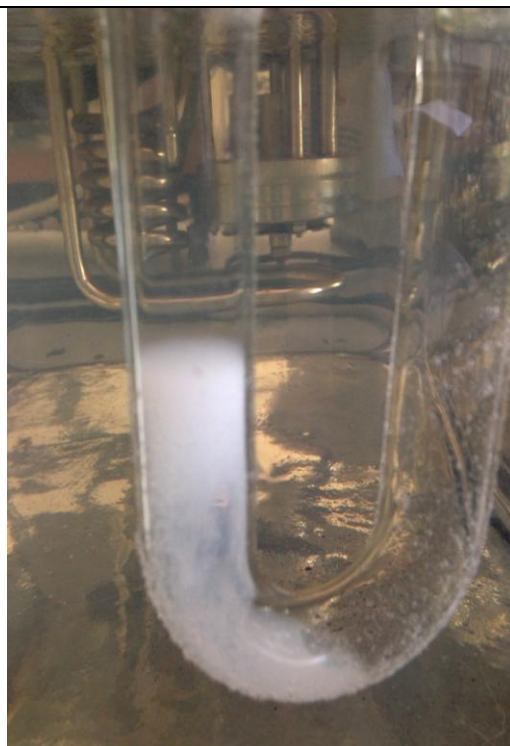
Рис. 2.3. Топологическая картина помутнения водной фазы в системе раствор винилацетата в метаноле – 0.4 % водный раствор, время наблюдения 70 мин.
