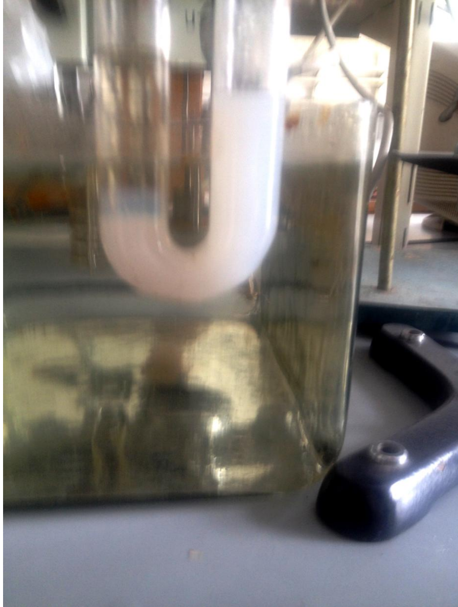
Рис. 2.23. Помутнение со стороны спирт – вода в системе ВА – вода – (спирт+ДАК), после 30 мин от начала введения в систему ПК.
