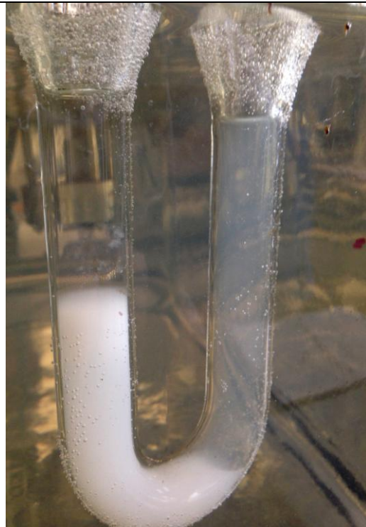
Рис. 2.5. Топологическая картина помутнения водной фазы в системе раствор винилацетата в метаноле – 0,4 % водный раствор, время наблюдения 130 мин.
