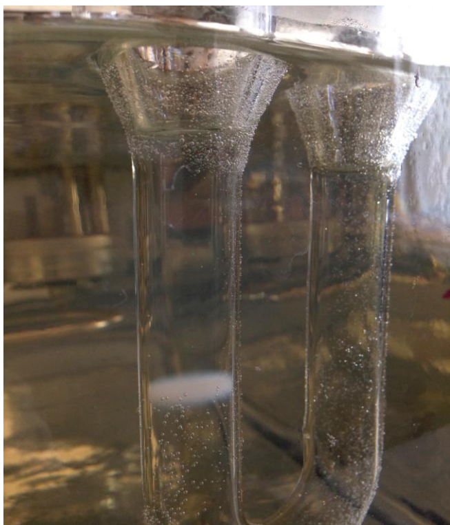
Рис. 2.1. Топологическая картина помутнения водной фазы в системе раствор винилацетата в метаноле – 0.4 % водный раствор персульфата калия в разные промежутки времени наблюдения (30 мин).
