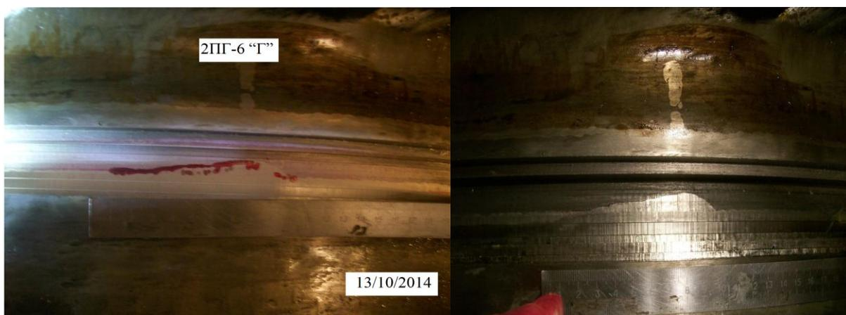
Рис. 3.28. Изображение индикации, полученной по результатам капиллярного контроля на глубине выборки 24 мм
