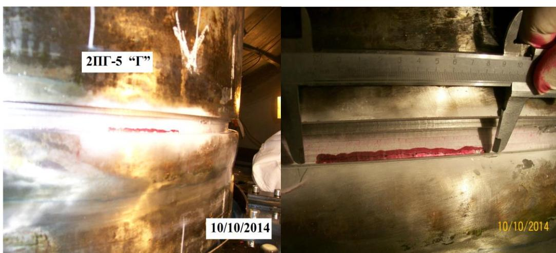
Рис. 3.22. Изображение индикации, полученной по результатам капиллярного контроля на глубине выборки 25 мм
