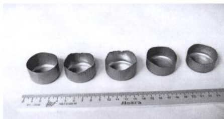
Рис.6. Цилиндрические детали, вытянутые из листового молибдена с применением дифференциального нагрева.
