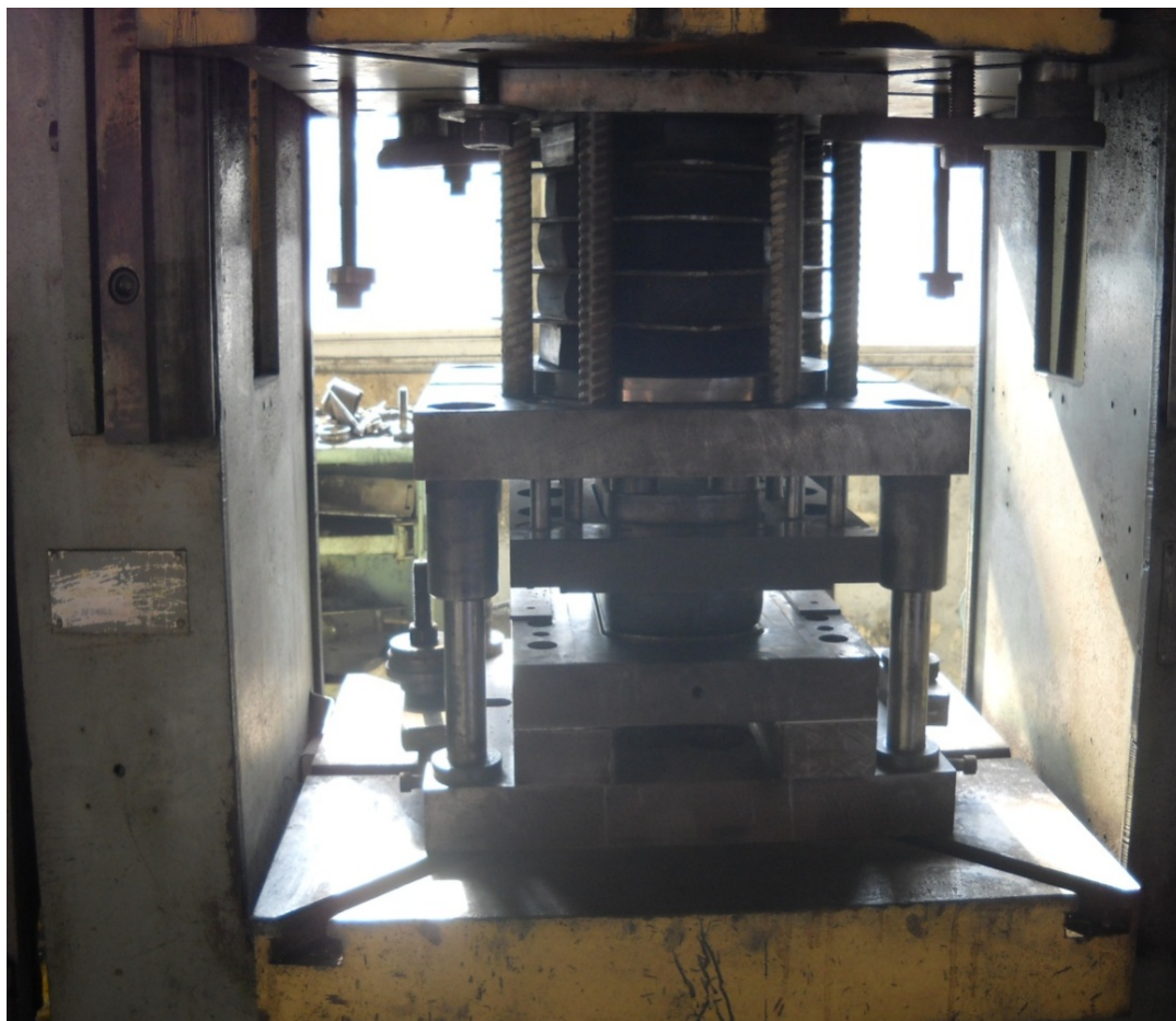
Рис. 4.14. Экспериментальный штамп для вытяжки контейнеров-лодочек
