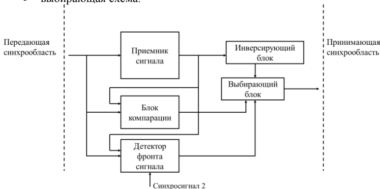
Рис. 8. Принципиальная структура предложенной системы синхронизации
