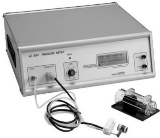
Նկար 8. Համակարգային զարկերակային ճնշման որոշման “tail-cuff” սարքավորում
