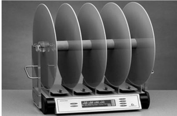
Նկար 7. «Մոտոր կոորդինացիոն» թեստի Rota-Rod սարքավորումը
