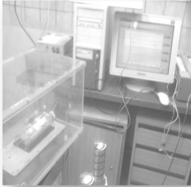
Նկար 8. Համակարգային զարկերակային ճնշման որոշման “tail-cuff” սարքավորում
