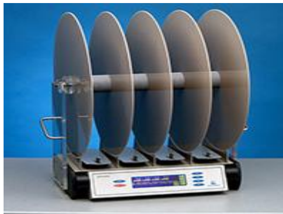
Рисунок 7. Установка “Вращающийся стержень” для определения координации крыс.
