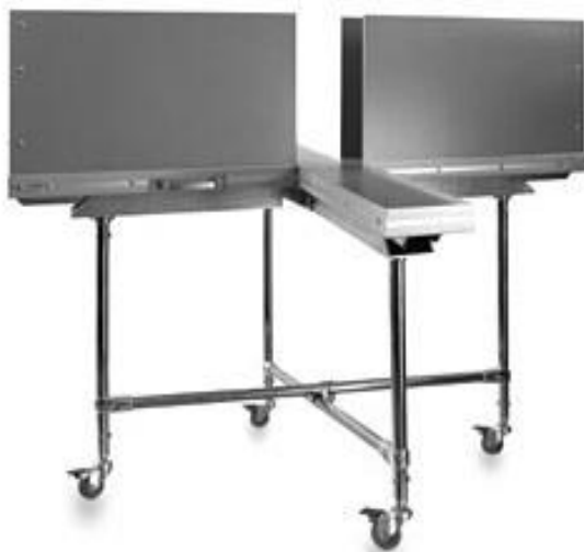
Рисунок 8. Установка «Приподнятый крестообразный лабиринт».
