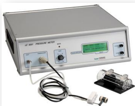
Рисунок 5. Аппарат для измерения артериального давления неинвазивным методом “Tail-Cuff”.
