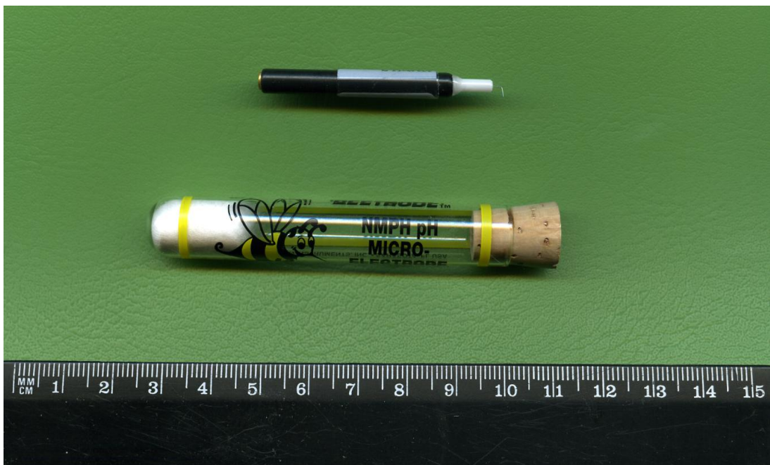
Рис. 2.7. Внутривитой рН-чувствительный электрод Solid-state FET pH/ATC-electrode, Denver Instrument Company, США.
