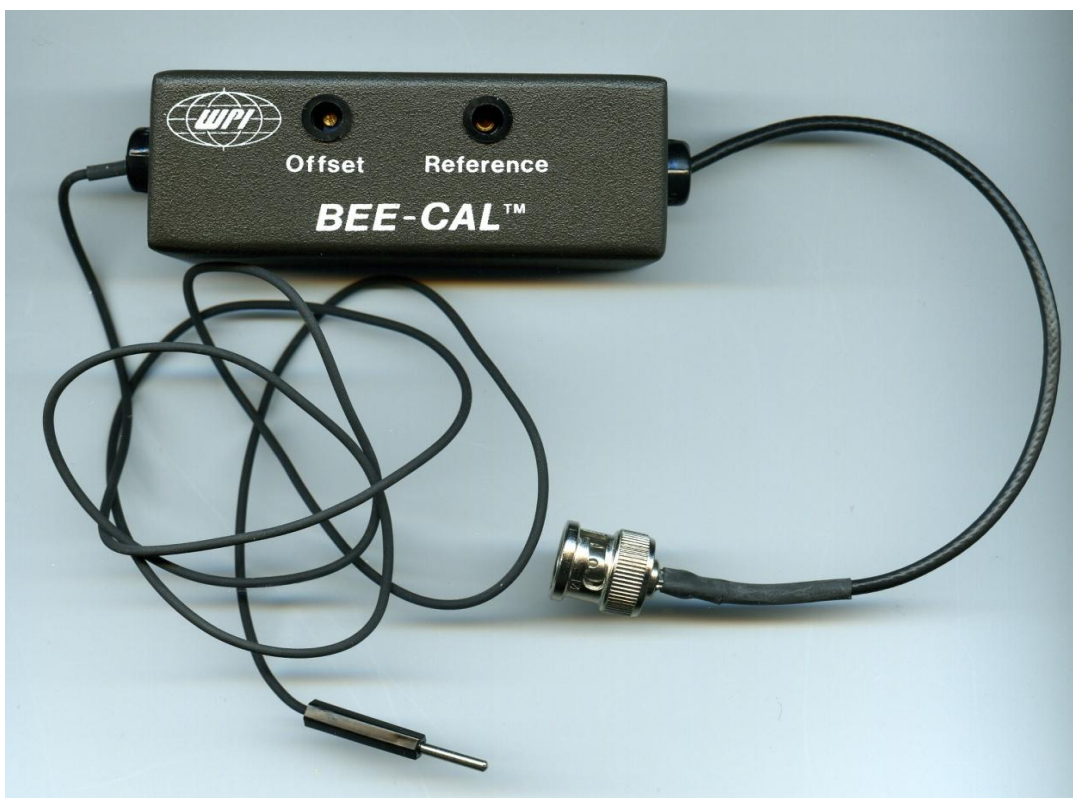
Рис. 2.8. Адаптер для внутриротовых рН-электродов «BeeCol™» (США).
