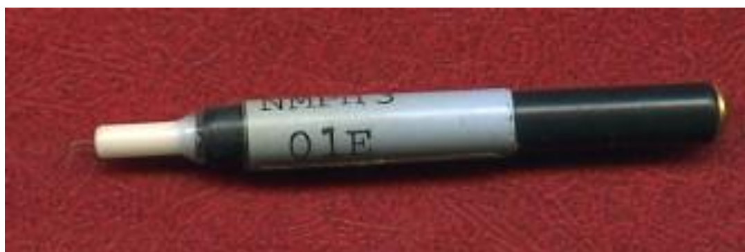
Рис. 2.9. Внутриротовой металлооксидный сурьмяный электрод.
