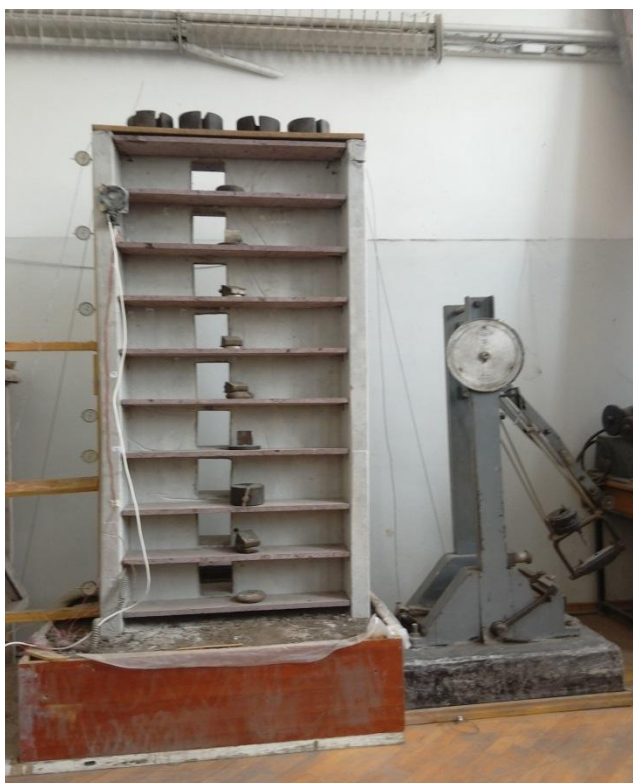
Рис. 7.16. Общий вид экспериментальной установки для испытания диафрагмы-модели
