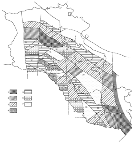
Նկ.3. Հայկական ՄՍՀ-ի և Նախիջևանի ԲՆՀ-ի երկրակեղևի բլոկային կառուցվածքի և բյուրեղային հիմքի դիրքի սխեման, ըստ երկրաբանաերկրաֆիզիկական տվյալների (Բ.Մելիքսեթյան և այլք, 1975): Հիմքի տեղադրման բացարձակ խորությունները (կմ). 1) +1.5 \pm 2.5 , 2) +1 \pm 1.5 , 3) +0.5 \pm 1 , 4) -0.5 \pm 0.0 , 5) -1.0 \pm 1.5 , 6) -2 \pm 2.5 , 7) -3 \pm 5 և այլեի:
