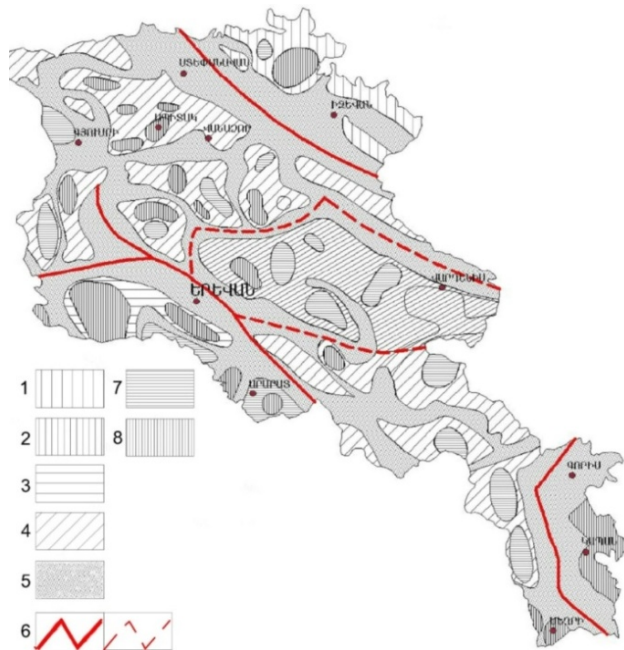
Նկ.9. ՀՀ տարածքի ծանրության ուժի անումայիաների շրջանացման սխեմատիկ քարտեզը: Տարածաշրջանային դաշտի տարբեր արժեքներով գոտիները. 1-բարձր, 2-քիչ բարձր, 3-միջին, 4-ցածր, 5-դաշտի բարձր գրադիենտների տարածաշրջանային ձգված գոտիներ, 6-դրանց առանցքները (զծիկներով տրված են ենթադրվող առանցքները): Տեղային բնույթի անումայիաները՝ 7-մաքսիմումներ, 8 - մինիմումներ:
