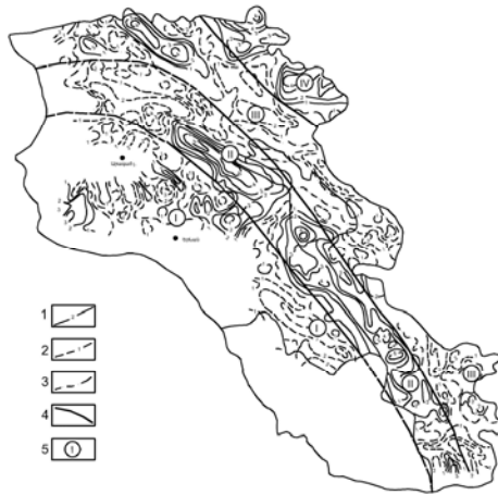
Նկ. 7. \Delta T_s անոմալ մագնիսական դաշտի 1:200 000 մասշտաբի սխեմատիկ քարտեզը, 1000-1200մ բարձրության հանույթի դեպքում (Գ.Սիրոտսկին և այլոք): Բզողինամները: 1-դրական; 2-զրոյական; 3-բացասական; 4-մագնիսական ենթագոնանների սահմանները; 5-մագնիսական ենթագոնանների համարները:
