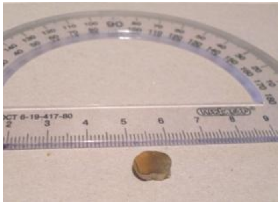
Նկ. 2.1. 585 հարգի սպիտակ ոսկու համաձուլվածքից պատրաստված ձուլված աճողից կտրված փորձանմուշները
