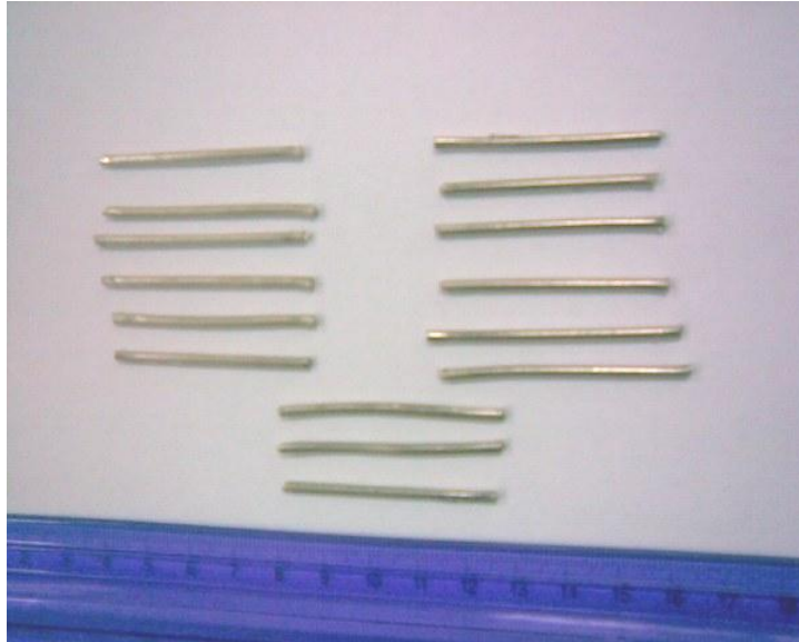
Նկ. 2.2. 585 հարգի սպիտակ ոսկու համաձուլվածքի սնուցիչներ հատված
