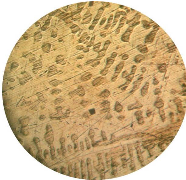
Նկ . 3.9. 585 հարգի 58,5%Au+26,8%Cu+8,6%Ni+6,1%Zn բաղադրությամբ համաձուլվածքի միկրոկառուցվածքը՝ 250°C-ում 2 ժամ 30 րոպե պահումից և վառարանում սառեցումից հետո, \times 270
