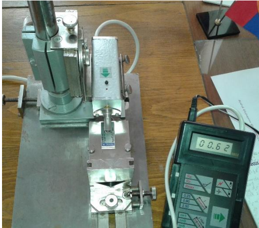
Նկ.3.18. Մակերևութային խորդուրորդությունների չափման АБРИС-ПМ7 մակնիշի պրոֆիլաչափի կարգաբերումը և արտաքին տեսքը
