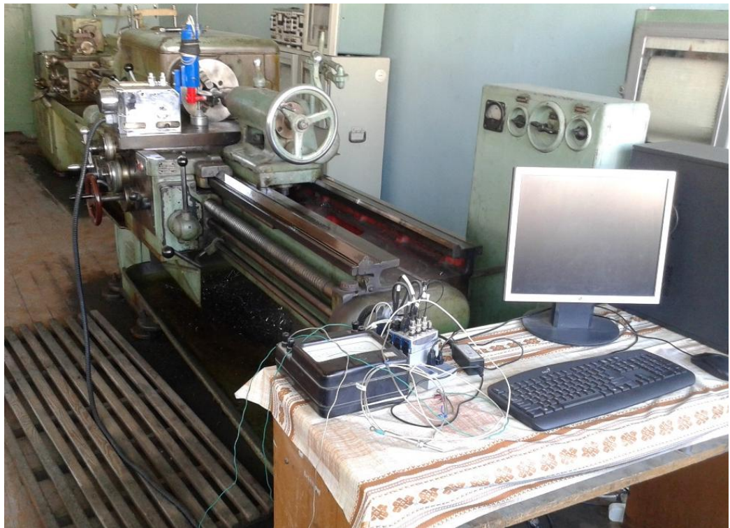
Նկ. 3. 10. STD.201-1 մակնիշի ուժաշարի միացման ա) սկզբունքային սխեմա [63] բ) տեղակայանքը
