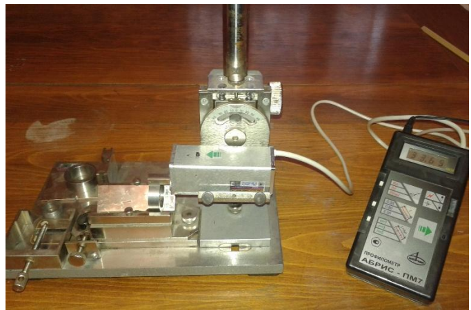
Նկ.3.18. Մակերևութային խորդուրորդությունների չափման АБРИС-ПМ7 մակնիշի պրոֆիլաչափի կարգաբերումը և արտաքին տեսքը
