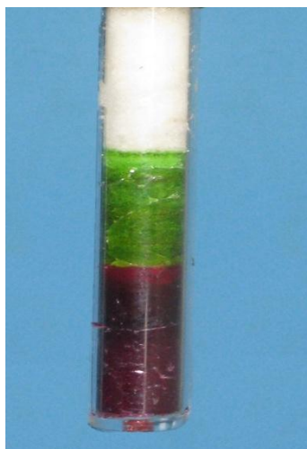
Рис. 4.1.1. Образец с градиентными свойствами, полученный методом фронтальной полимеризации.
