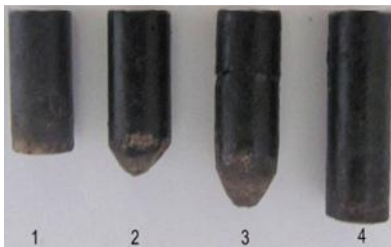
Рис.2.6.4. Изменение геометрической формы фронта от времени. Время в сек. (начало отсчета соответствует точке 1 на рис. 2.6.3) 0 – 1, 20 – 2, 40 – 3 и 50 – 4.
