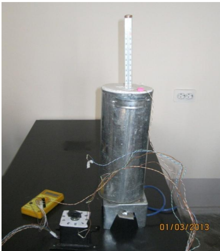
Рис. 2.5. Процесс градуировки терморезисторов.
