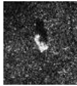
Նկար 3.16. Արհեստական արբանյակից 15^\circ անկման անկյան տակ արված միևնույն տիպի տանկերի SAR պատկերներ, որոնք նկարելու պահին ունեցել են տարբեր աստիճանի թեքվածություն նկարող սարքի նկատմամբ:
