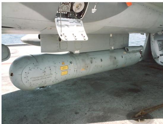
Рис. 1.19. Подвесная лазерная станция подсвета и дальнометрирования «ATLIS» на самолете Super Entendard
