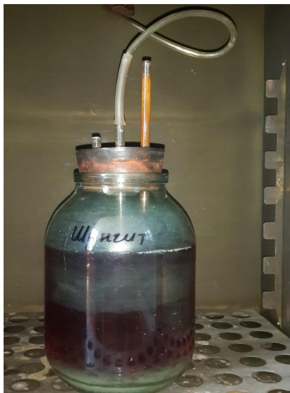
Рис. 34. Иммобилизация Acidithiobacillus sp. 13 Zn на шунгите (Т - 37°C, перемешивание через продувания)
