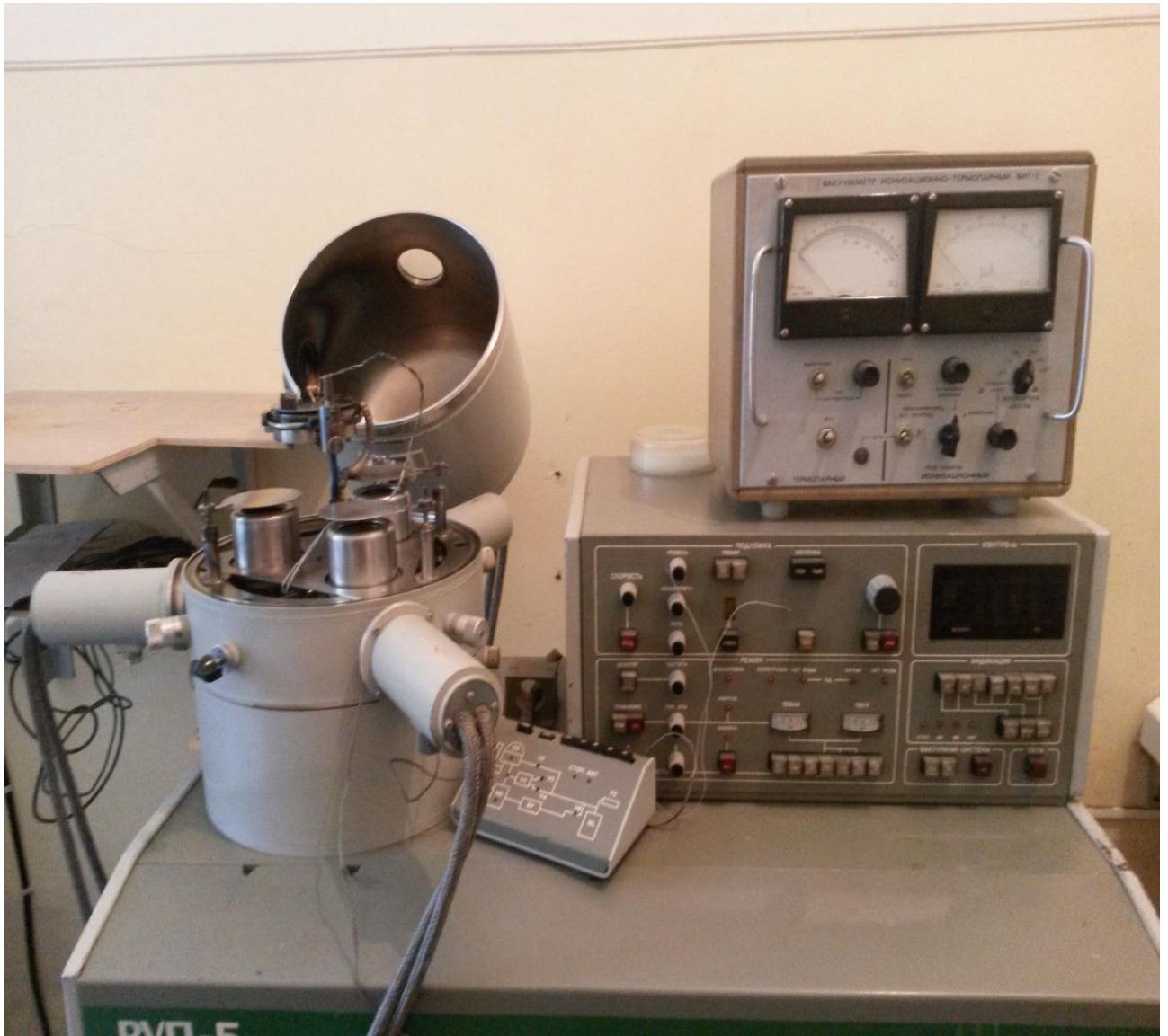
Նկար 4: Գլանաձև անոթով և հարթ կաթոդով մագնետրոնային համակարգի պատկերը:
