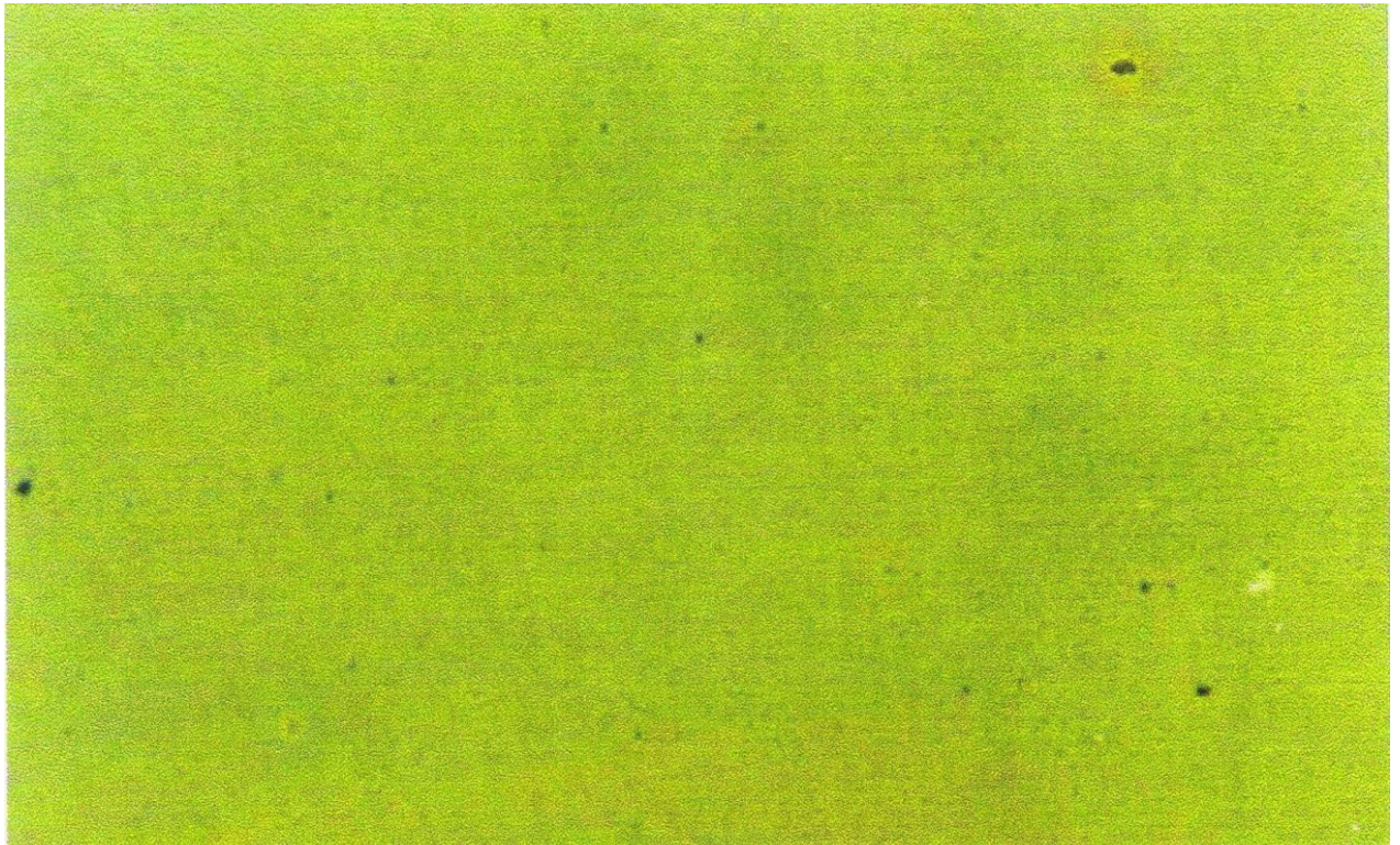
Նկ. 2.8. Օպտիկական միկրոսկոպով (100x) ստացված ZnO (աղյուսակ 2.1, N2) թաղանթի լուսանկարը:
