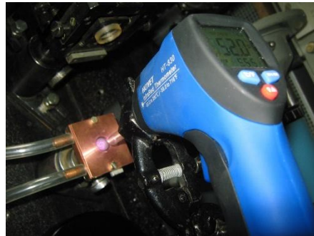
Рис. 25 Лазерная система имитации нагрева от пучка и система криогенного охлаждения. На правом рисунке красное пятно в центре мишени – инфракрасное излучение от мишени, нагретой лазерным пучком.
