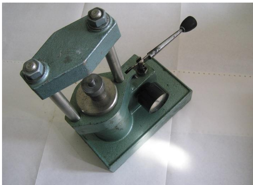
Рис. 11. Пресс с матрицей и пуансоном для прессования молибдена в форме диска.
