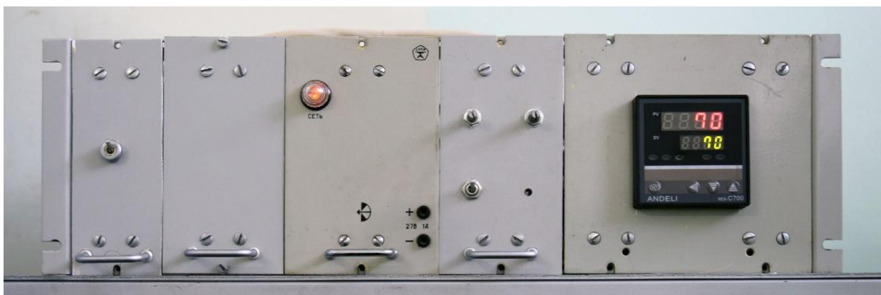
Рис. 42 Блок управления для автоматической подачи соляной кислоты в колбу с FeS и терморегулирования водяной бани.
