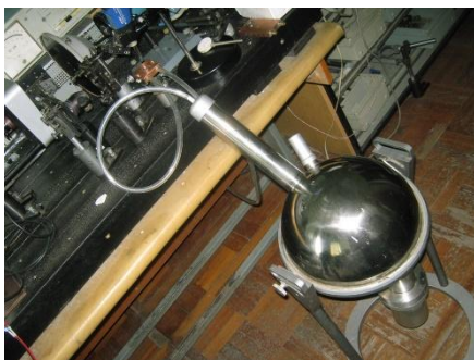
Рис. 25 Лазерная система имитации нагрева от пучка и система криогенного охлаждения. На правом рисунке красное пятно в центре мишени – инфракрасное излучение от мишени, нагретой лазерным пучком.
