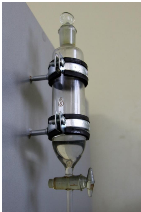
Рис. 41 Слянка с соляной кислотой, которая подавалась в колбу с сульфидом железа.
