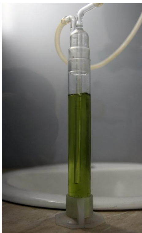
Рис. 43 Барботер с щелочным раствором изменившим цвет после сероводорода через него.
