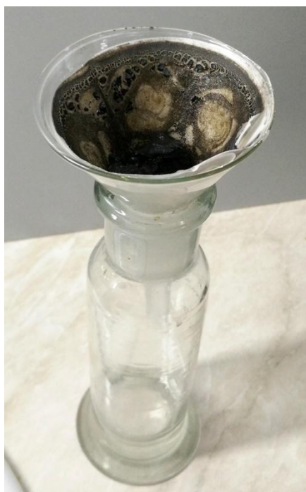
Рис. 45 Процесс промывки осадка сульфида молибдена дистиллированной водой.
