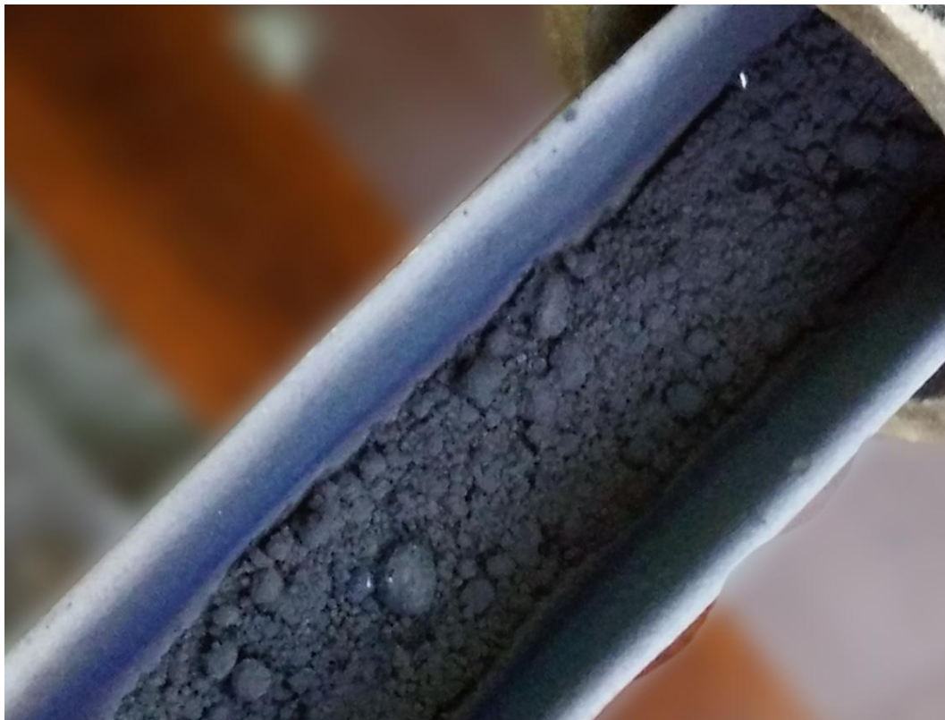
Рис. 50 Результат восстановления оксида молибдена \text{MoO}_3 до металлического Mo водородом.
