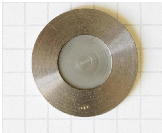
Рис. 17. Мишенный диск с запрессованным природным молибденом (в центральном круге).
