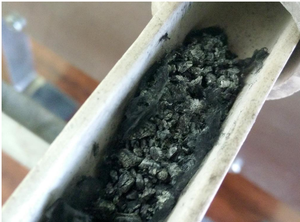
Рис. 48 Результат восстановления сульфида молибдена \text{MoS}_3 до оксида молибдена \text{MoO}_3 .
