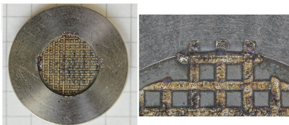
Рис. 19. Мишенный диск с молибденом после дополнительного усиления контакта с мишенным диском в 4 точках (слева), с 30-кратным увеличением (справа).
