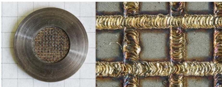
Рис. 18 Мишенный диск с запрессованным молибденом после лазерной обработки (слева), с 40-кратным увеличением (справа).
