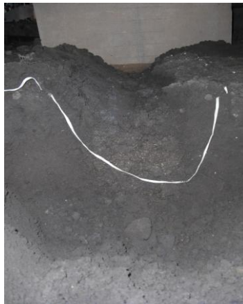
Նկ. 4.12. Հարթ սկավառակային ակոսահանի թեքման անկյան ազդեցությունը սաժիլված շարքի դիմացի (խտացված) ակոսապատով ջրի ներծծման վրա գիտափորձի ընդհանուր տեսքը:
