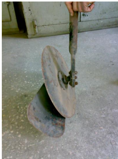
Նկ. 3.4. Ակոսահանի սկավառակի դիրքի կարգավորման անվակունդի ընդհանուր տեսքը:
