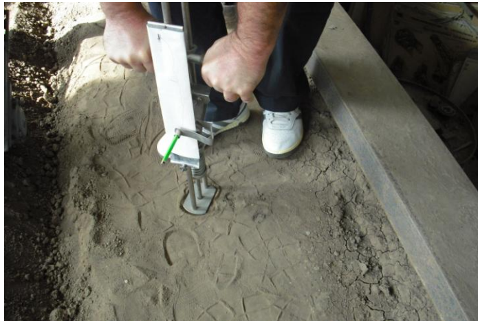
Նկ. 3.8. Հողի ամրության և ծավալային տրորման գործակցի որոշման անհրաժեշտ չափումները Յու. Ռեյակինի ամրաչափով:
