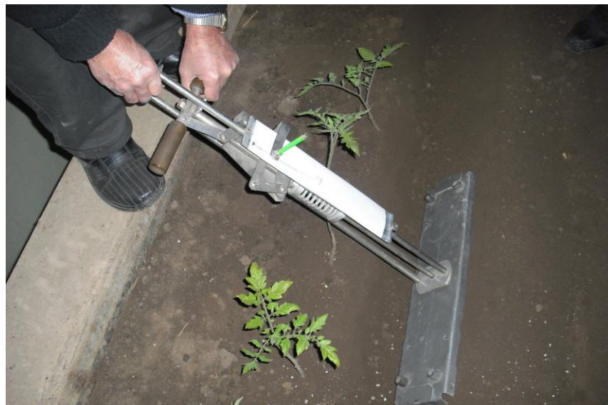
Նկ. 3.11. Ոռոգման ակոսապատի ամրության չափումը Յու. Ռեյակինի ամրաչափով:
