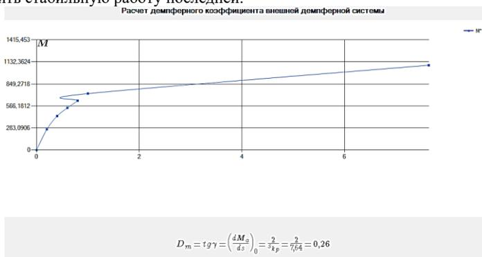
Рис. 11. Расчет демпферного коэффициента ВДС
