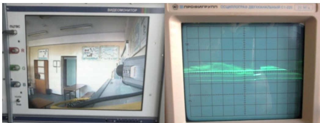
Рисунок 3.4 – Изображение и осциллограмма видеосигнала при нормальной работе без помехи
