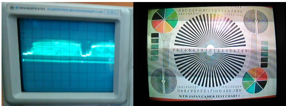
Рисунок 4.11 - Уровень выходного сигнала и изображение тестовой таблицы с видеомонитора, полученные при использовании цветной видеокамеры ТАТ-603S, 420 ТВЛ при освещении RGB светодиодами.
