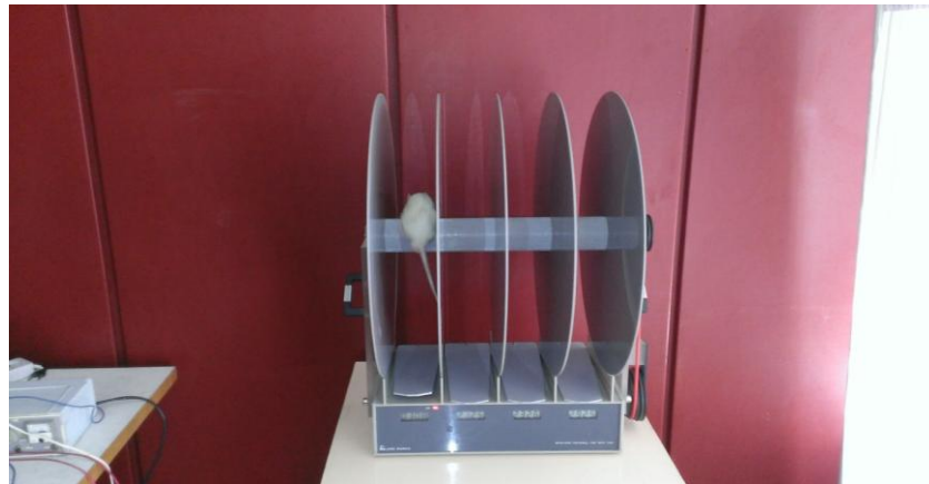
Նկար 10. Առնետների շարժողական կոորդինացիայի գնահատման «Պտտվող ձող» սարքավորումը
