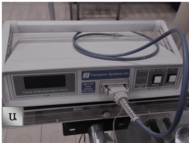
Նկար 6. Ա - BLF-21 դոպլերային հոսքաչափի N տեսակի ասեղնաձև գրանցիչով
