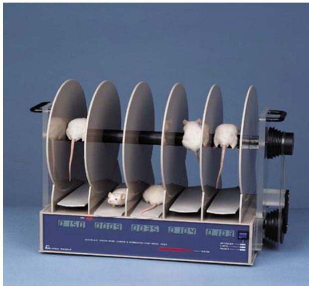
Նկ.2.9 Առ ն ե տ ն ե ր ի կ ո ո ր դ ի ն ա ց ի ա յ ի ո ր ո շ մ ա ն «Պ տ ս վ ո ղ ձ ո ղ » ս ա ր ք ը
