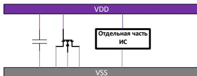
Рис.7. Совместное применение конденсаторов МОП и MOM в качестве развязывающих конденсаторов
