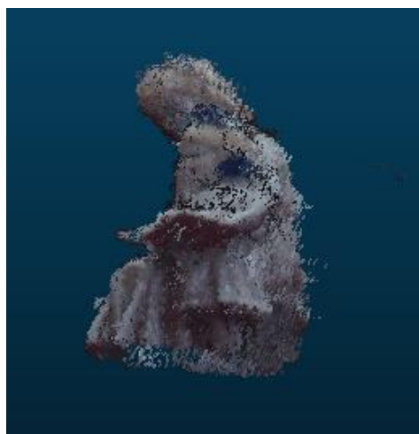
Рисунок 3.21: 3D модель статуи после регистрации облаков точек.
