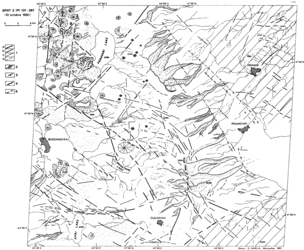
Նկար 1.4 Ջավախքի բարձրավանդակի խզումները (1-խզվածքներ (a- մակերեսին խիստ արտահայտված ձևախախտումներով, b- մակերեսին արտահայտված ձևախախտումներով, c- մակերեսին քիչ արտահայտված ձևախախտումներով, d- մակերեսին շատ թույլ արտահայտված ձևախախտումներով), 2- կողաշարժային խզվածքներ, 3- վերնետքային խզվածքներ, 4- վարնետքային խզվածքներ, 5- սկարպեր) [132]
