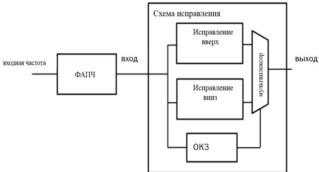
Рис. 3.10. Блок-диаграмма коррекции коэффициента заполнения сигнала
