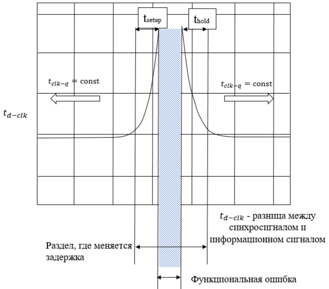
Рис. 1.19. Зависимость синхросигнала и информационного сигнала ( t_{d-clk} ) от задержки триггера ( t_{clk-q} )
