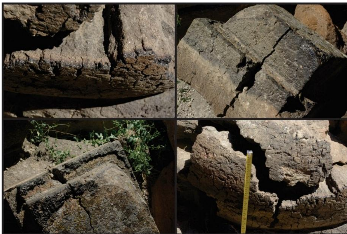
Рис.3.21. Следы воздействия огня на туфовых фрагментах храмового комплекса Звартноц.
