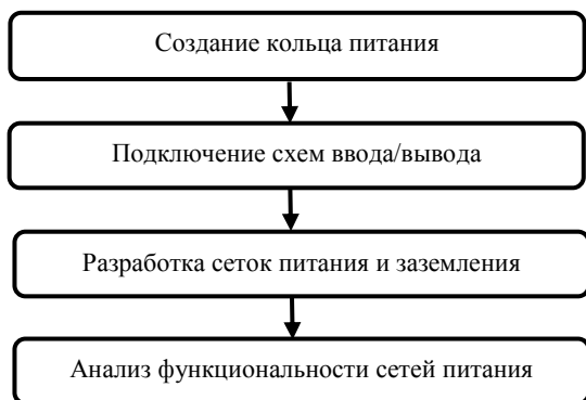
Рис. 4. Традиционный маршрут проектирования сетей питания ИС
