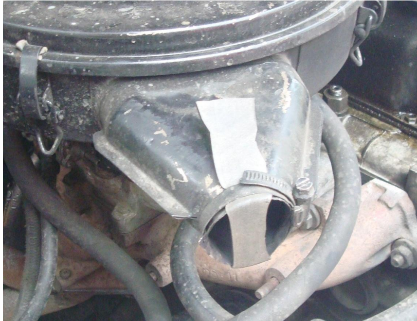
Նկ. 4.1. ՆԱՇ-ի կոլեկտոր մտնող օդի հոսքի սահմանափակող դիաֆրագմայի տեսքը օդի ֆիլտրի բկանցքի վրա
