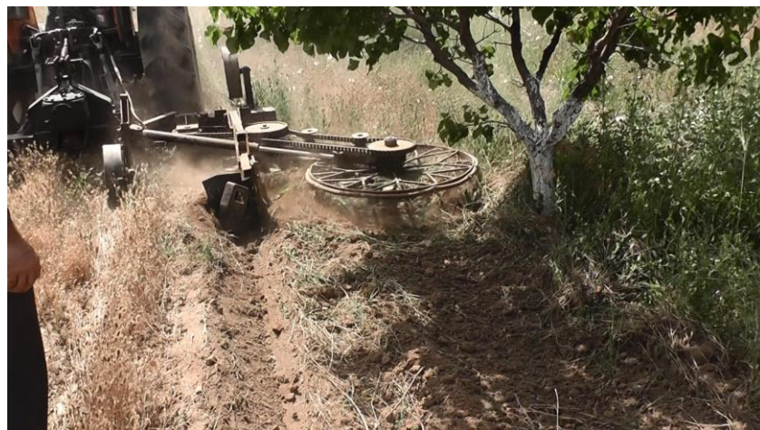
Նկ. 3.2. ՊԱՄ-1 այ գեփոր ագրեգատի աշխատանքը պողատու այգում:
