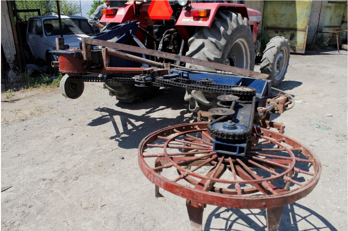
Նկ. 31. ՊԱՄ-1 ֆրեզ մեքենայի փորձանմուշի ընդհանուր տեսքը տրակտորի հետ ագրեգատավորված
