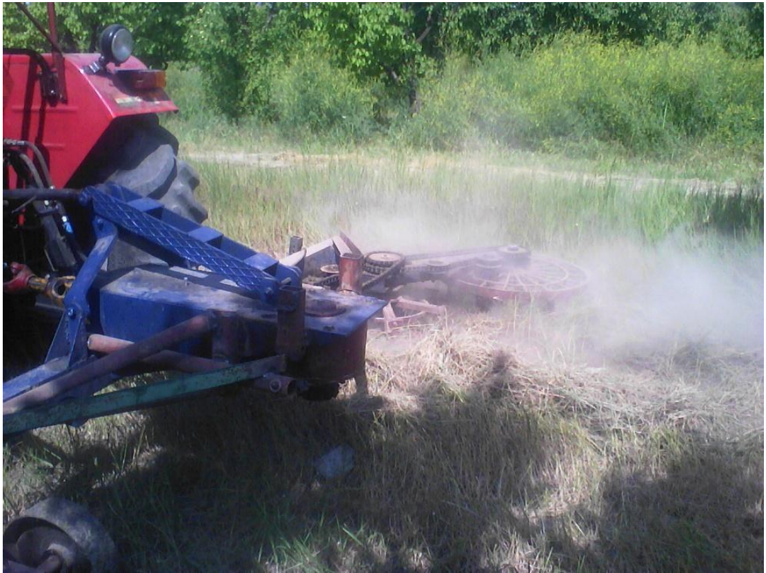
Նկ. 35. ՊԱՄ-1 ֆրեզմեքենան մերձբնային տարածությունն մշակելիս
