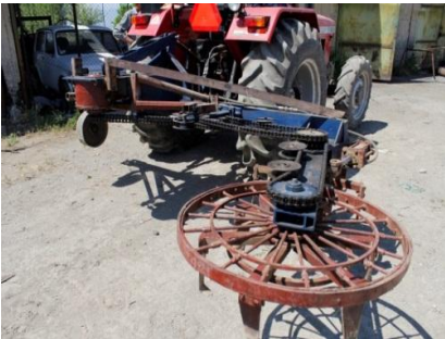
Նկ.8. ՊԱՄ-1 ֆրեզմեքենայի փորձանմուշի ընդհանուր տեսքը տրակտորի հետ ագրեգատավորված։
