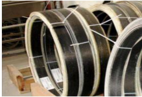
Նկ. 3.26 FibARM Lamel տեսակի ածխապլաստիկային հպաթիթեղի տեսքը
