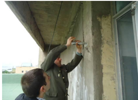
Նկ. 2.11. ՊՆ համար N զորամասի զորանոցի բետոնի փաստացի ամրության որոշման դրվագներ <<Շմիդ-Համեր>> գործիքով
