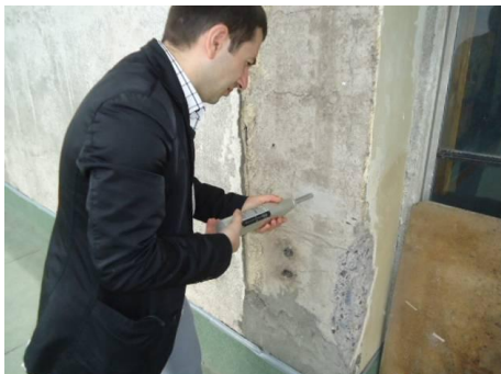
Նկ. 2.11. ՊՆ համար N զորամասի զորանոցի բետոնի փաստացի ամրության որոշման դրվագներ <<Շմիդ-Համեր>> գործիքով
