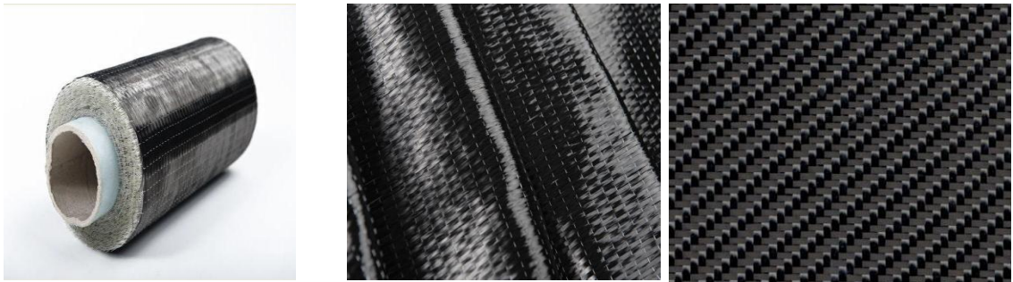
Նկ. 3.24 FibrARMTape տեսակի ածխածնային թելքերով կտորի տեսքը
