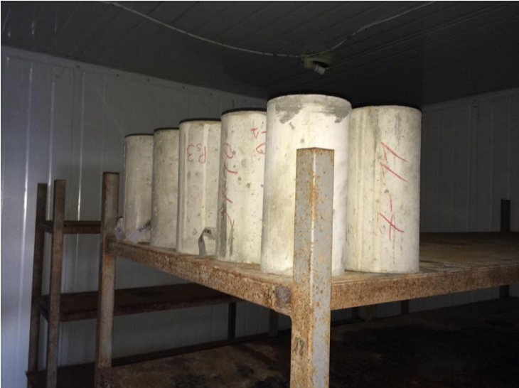
22 23 ՆԿ.3.7 Բետոնե փորձանմուշները խոնավացման 24 խցիկում 25
