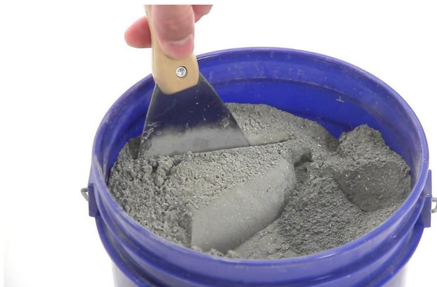
Նկ.2.1 Ներթափանցող ջրամեկուսացնող խառնուրդի օրինակ
