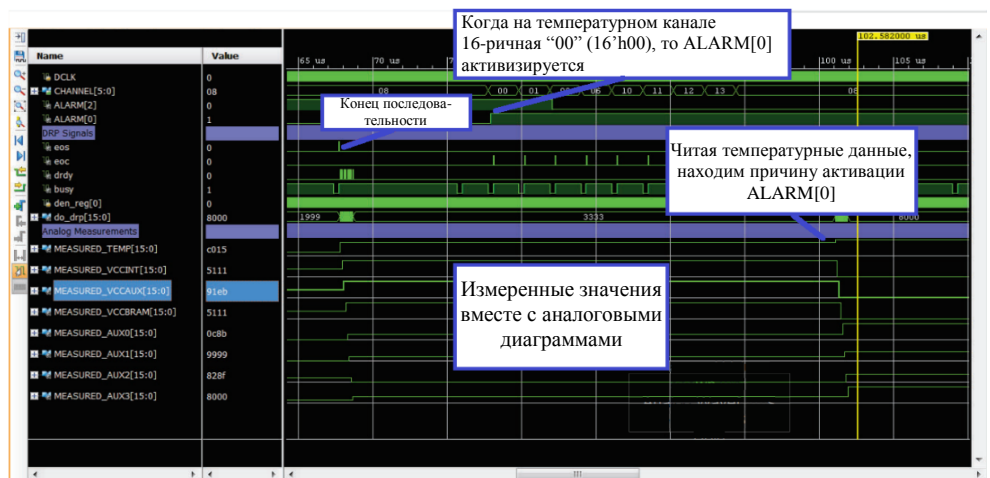
Рис. 13. Результаты логического моделирования узла обработки сигнала в среде iSim
