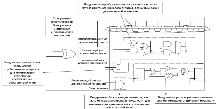
Рис. 7. Структурная схема предложенного метода контроля мощностей
