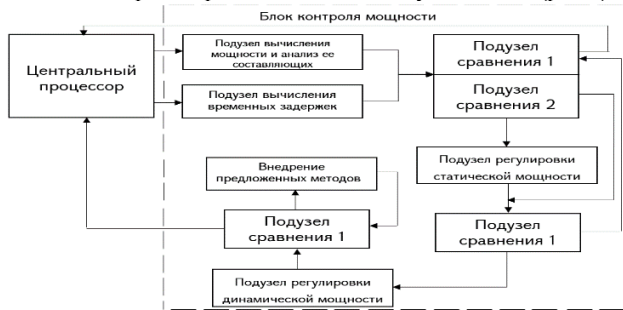
Рис. 6. Блок-схема предложенного метода контроля мощностей
