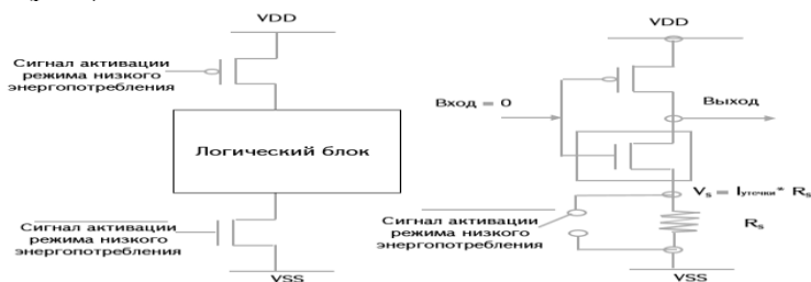
Рис. 5. Разновидности метода стробирования мощности
