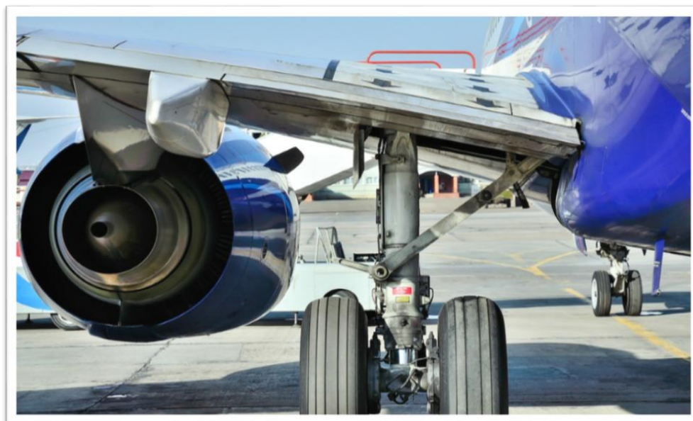
Рис. 2.3.1. Компоновка двигателя и шасси в крыле самолета
