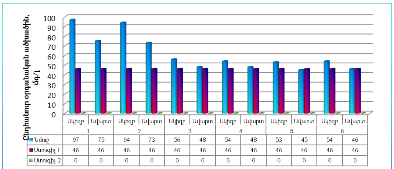
Նկար 52. Ընդհանուր օրգանական ածխածնի պարունակությունը, մգ/լ «ԱՐԱՐԱՏ» բնական հանքային ջրի արտադրական շղթայում. 1-կուրակի բաք (կապտածի), 2-ջրադար մեքենա, 3-կուրակի բաք (գործարանի), 4- սափուրապոր, 5-շալցման և խցանավորման մեքենա (ՊԷՏ), 6- շալցման և խցանավորման մեքենա (ապակի)
