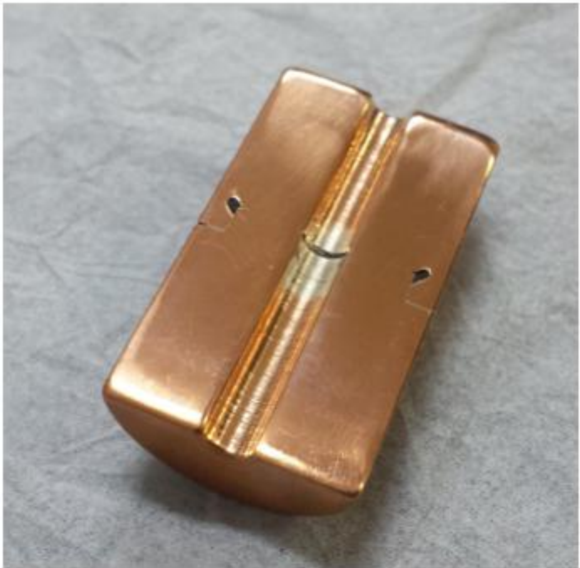
Նկ. 3.6(ա) - Պղնձե փորձանմուշի կտրվածք տեսքը (զոդանյութը ներթափանցած ներքին մակերևույթներին)
