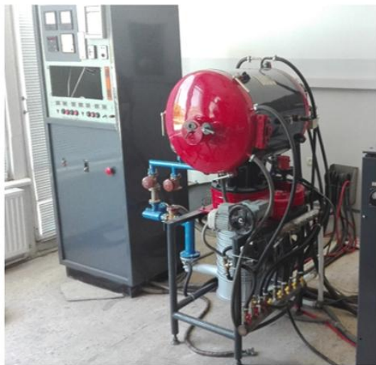
Նկ. 2.20 Վակուումային հորիզոնական վառարան իր տեխնիկական տվյալներով
