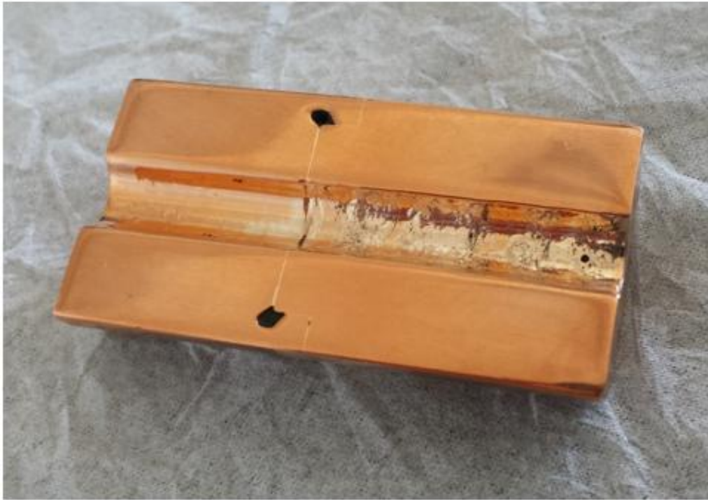
Նկ. 3.6(բ) - Պղնձե փորձանմուշի կտրվածք տեսքը (զոդանյութը ներթափանցած ներքին մակերևույթներին)
