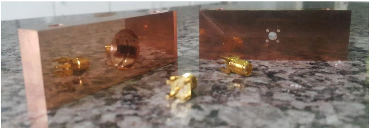
Նկ. 2.17 Միամոդային երկշերտ արագացնող կառուցվածքի փորձարարական հանգույցի դետալները
