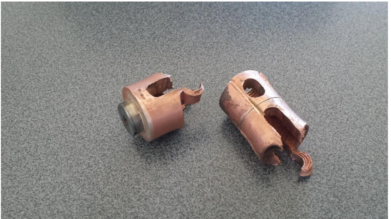
Նկ. 3.11 Չժանգոտվող պողպատի և պղնձի վակուումում զոդված փորձանմուշների քայքայման ենթարկված արդյունքները
