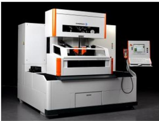
Նկ. 2.15 Charmilles Robofil 2050TW էլեկտրաէռոզիոն հաստոցի ընդհանուր տեսք իր տեխնիկական տվյալներով
