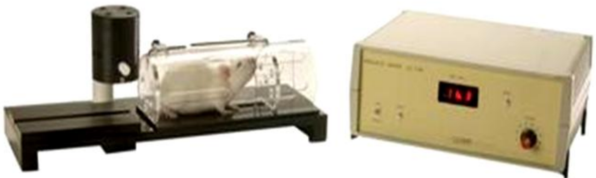
Նկար 10. Հականոցիցեպտիվ ակտիվության որոշման «Tail-flick» սարք
