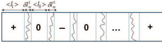
Рис. 8: Структура с нерегулярностями, которая состоит из нелинейных доменов, со средней длиной l_1 , с коэффициентами нелинейности \chi_+ > 0 и \chi_- < 0 , а также включает в себя линейные домены, со средней длиной l_0 . На схеме изображены сдвиги границ слоев по отношению к средней длине каждого n -ого домена.
